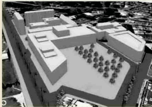
La cartografía vectorial en 3D, combinada con ortofoto (una imagen preparada para que todos los elementos estén en la misma escala).
