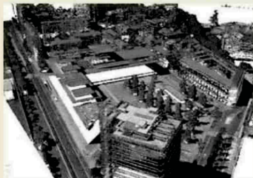
La representación de puntos LiDAR con imágenes tomadas con ángulos nadirales y oblicuos.
