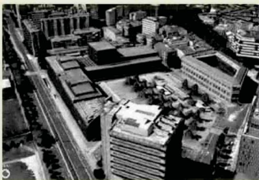
Un modelo en 3 dimensiones generado a partir de imágenes nadirales y oblicuas.
