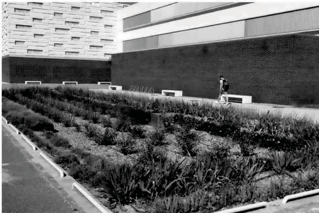
Aparcamiento de la UPNA en Tudela, donde se ha habilitado un jardín de drenaje que gestiona de manera natural el agua de lluvia. BLANCA ALDANONDO
