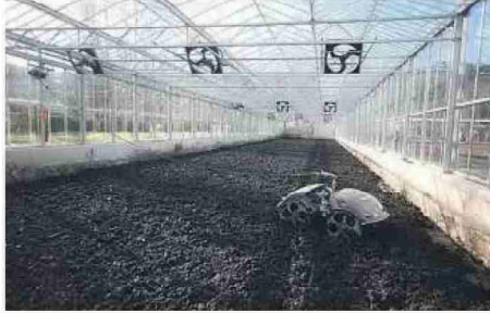
El robot voltea los lodos para facilitar el secado.
