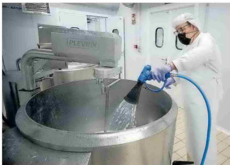
Juanjo limpia con una manguera la cuba donde se ha pasteurizado la leche.
